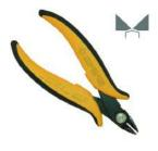
Utensile dal taglio smussato con trattamento speciale dei taglienti ad INDUZIONE capace di tagliare filo di rame e filo ferroso. Spessore 3 mm, lunghezza utensile 138 mm.
