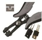
Utensile speciale studiato per la preformatura a passo 3,0 mm del gambo centrale del TO 220.
