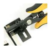
Utensile studiato per il taglio di PIN STRIP sia dritti che angolati. La lamina registrabile permette la regolazione dei differenti passi degli strip. Lamina per il taglio degli strip angolati compresa. È possibile personalizzare la lamina di regolazione in lunghezza.
