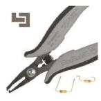
Utensile speciale dal taglio frontale, studiato per accedere in zone affollate. È in grado, con una sola operazione, di tagliare e piegare il componente bloccandolo sul circuito.
