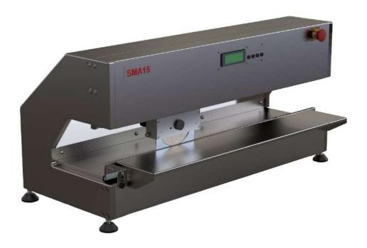
Separatrice motorizzata di schede preincise, progettata per risolvere esigenze di separazione di circuiti in alluminio e FR4 soprattutto presenti nel settore dell'illuminotecnica.
