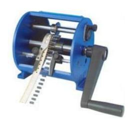
Il modello TP6/R viene utilizzato per tagliare i componenti radiali nastrati. La macchina può essere fornita per adattarsi ai due tipi più comuni di nastratura, cioè con fori a passo 12,7 o 15 mm. È semplice comunque variare tale quota sostituendo alcune parti fornite con la macchina. La qualità ed affidabilità di questa macchina consentono di operare per anni senza rischi di usura delle parti meccaniche e con pochi interventi di manutenzione.
