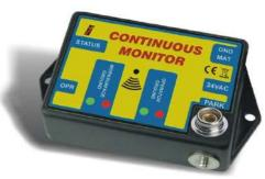
Strumento che verifica in modo continuo il sistema di messa a terra dell'operatore e di una superficie di lavoro ESD. Questo monitor usa la tecnologia "wave distortion" per evitare falsi allarmi causati dal 50Hz e da altre interferenze elettromagnetiche ed elettrostatiche. Alimentazione: 24 V AC.
