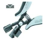
Utensile speciale che in una sola operazione taglia e preforma a 90° i componenti. Possibilità di regolare la distanza per mezzo di una lamina registrabile.
