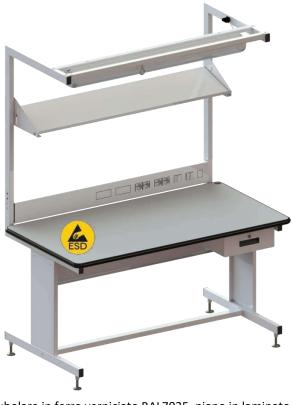
Struttura tubolare in ferro verniciato RAL7035, piano in laminato statico dissipativo ESD 1200 x 800 x h30 mm con bordatura in ABS nero con angoli arrotondati.
