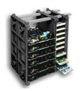
Telai regolabili per il trasporto e lo stoccaggio di PCB.
