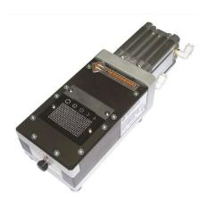
La MMP10 è una macchina pneumatica per il taglio di componenti sfusi (transistor, led, condensatori, resistenze, ecc.). L'altezza del taglio standard è di 3 mm ma può essere variata aggiungendo la mascherina in dotazione (altezza 1,5 mm). Il diametro dei componenti che la macchina riesce a tagliare varia da 0,3 a 1,3 mm per un numero massimo di 60 gambini.
