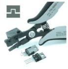
Utensile speciale che con una sola operazione permette di piegare a 90° il componente TO 220 in modo tale che il gambo centrale risulti più lungo di 3,81mm rispetto ai laterali. È possibile regolare la distanza per mezzo di una lamina registrabile (min 3 mm).
