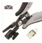
Utensile speciale adatta per la preformatura di componenti a 90°. Dotato di una lamina registrabile per regolare la distanza di preformatura (A) Larghezza di preformatura max 16 mm, così da permettere la preformatura del TO 220, TO 247 e altre tipologie.
