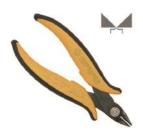
Utensile dal taglio raso con trattamento speciale dei taglienti ad INDUZIONE capace di tagliare filo di rame e filo ferroso. Spessore 3 mm, lunghezza utensile 138 mm.
