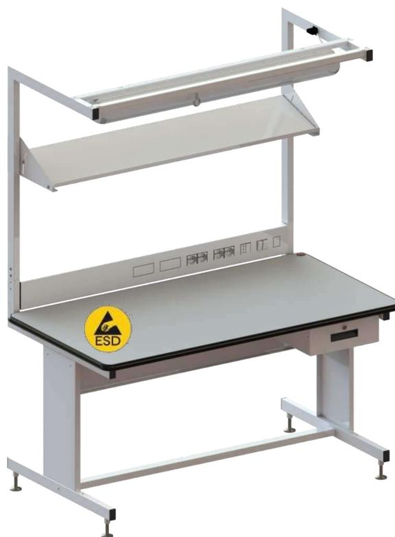
Struttura tubolare in ferro verniciato RAL7035, piano in laminato statico dissipativo ESD 1500 x 800 x h30 mm con bordatura in ABS nero con angoli arrotondati.
