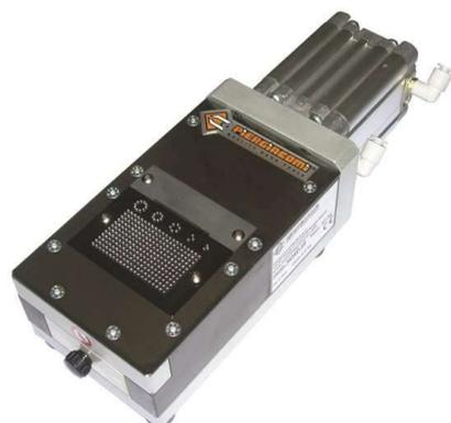
La MMP10 è una macchina pneumatica per il taglio di componenti sfusi (transistor, led, condensatori, resistenze, ecc.). L'altezza del taglio standard è di 3 mm ma può essere variata aggiungendo la mascherina in dotazione (altezza 1,5 mm). Il diametro dei componenti che la macchina riesce a tagliare varia da 0,3 a 1,3 mm per un numero massimo di 60 gambini.
