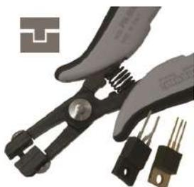
Utensile speciale studiato per la preformatura a passo 3,0 mm del gambo centrale del TO 220. Spessore 5 mm    Ø filo: 1,30 mm
