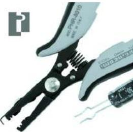
Utensile speciale che in una sola operazione taglia e preforma a C con 2 anse contrapposte entrambi i gambini dei componenti. Possibilità di regolare la distanza per mezzo di una lamina registrabile.
