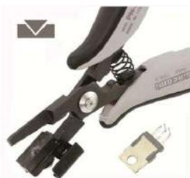
Utensile speciale adatta per la preformatura di componenti a 90°. Dotato di una lamina registrabile per regolare la distanza di preformatura (A). Larghezza di preformatura max 16 mm, così da permettere la preformatura del TO 220, TO 247 e altre tipologie. Spessore 5 mm    Ø filo: 1,30 mm
