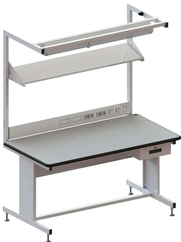
Struttura tubolare in ferro verniciato RAL7035, piano in laminato 1200 x 800 x h30 mm con bordatura in ABS nero con angoli arrotondati.
