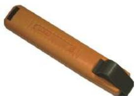
Sguainacavo per cavi  $\varnothing$  da 8 a 28mm con lama interna regolabile. Dotato al suo interno di una lama di ricambio.
