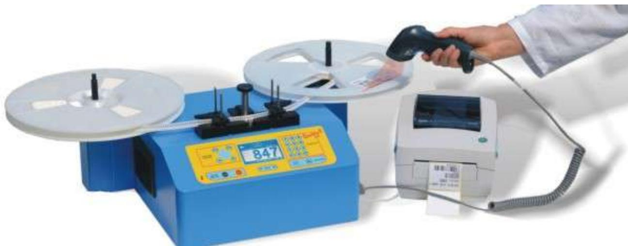
La contapezzi motorizzata S-EVO esegue il conteggio di componenti SMD nastri. Il conteggio viene effettuato contando i fori del nastro di supporto. Vi sono due modalità di funzionamento:
