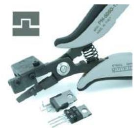
Utensile speciale che con una sola operazione permette di piegare a 90° il componente TO 220 in modo tale che il gambo centrale risulti più lungo di 3,81mm rispetto ai laterali. È possibile regolare la distanza per mezzo di una lamina registrabile (min 3 mm). Spessore 5 mm    Ø filo: 1,30 mm
