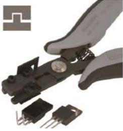
Utensile speciale che con una sola operazione permette di piegare a 90° il componente TO 220 in modo tale che il gambo centrale risulti più lungo di 2,54 mm rispetto ai laterali. È possibile regolare la distanza per mezzo di una lamina registrabile.
