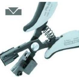
Utensile speciale che in una sola operazione taglia e preforma a 90° i componenti. Possibilità di regolare la distanza per mezzo di una lamina registrabile.
