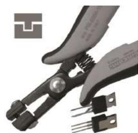
Utensile speciale studiato per la preformatura a passo 2,54mm del gambo centrale del TO 220. Spessore 5 mm    Ø filo: 1,30 mm
