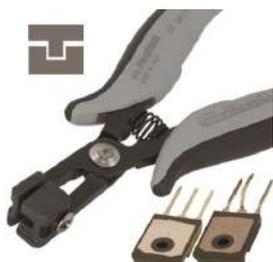
Utensile speciale studiato per la preformatura a passo 5,08 mm del gambo centrale del TO 220 e del TO247. Spessore 5 mm    Ø filo: 1,30 mm
